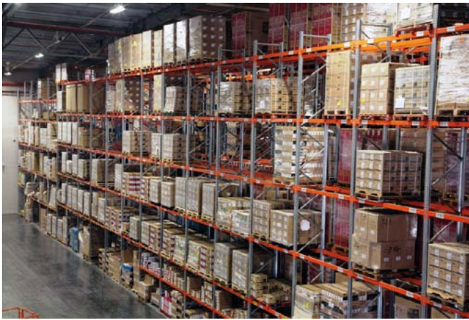
מערכת קונבנציונלית לאחסון משטחים בשורות (CPR)
